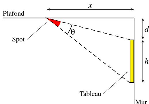
L'angle  $\theta$  que doit couvrir le spot pour éclairer le tableau dépend de la distance  $x$  par la relation
