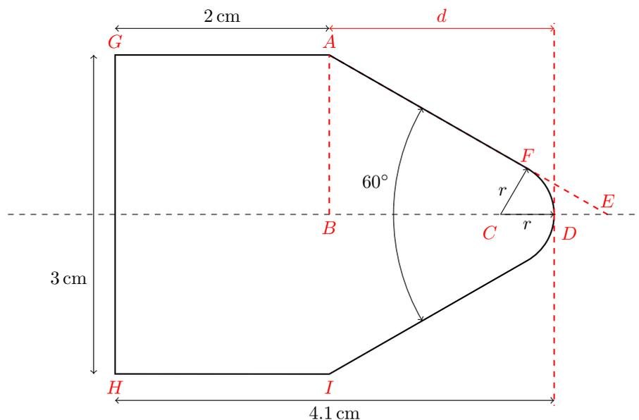
Les segments horizontaux  $AG$  et  $HI$  sont parallèles et, par symétrie de la pièce, sont perpendiculaires au segment  $GH$ . En conséquence, le segment  $AB$  est perpendiculaire à l'axe de symétrie  $BE$  et sa longueur vaut la moitié de celle de  $GH$ . Le triangle  $ABE$  ainsi défini est rectangle en  $B$  et nous pouvons écrire :
