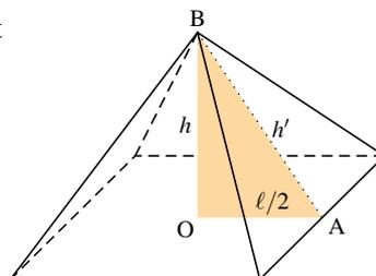
Pour répondre à la question, il convient de minimiser cette aire. Cependant, les dimensions  $\ell$  et  $h$  ne sont pas indépendantes puisque la bâche doit abriter un volume  $V$  fixé. Le volume d'une pyramide étant égal au tiers du produit de l'aire de la base et de la hauteur, on exprime aisément ce volume  $V$  en fonction des dimensions  $\ell$  et  $h$  sous la forme
