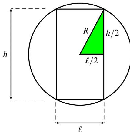
En appliquant la relation de Pythagore dans le triangle identifié sur la figure ci-dessus, on peut exprimer la relation entre les dimensions de la poutre sous la forme
