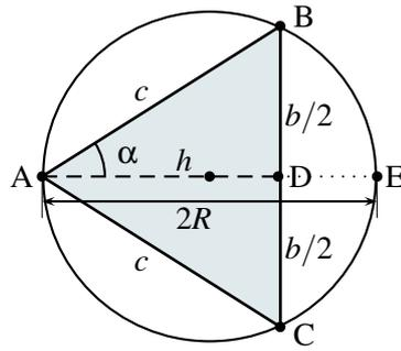
En adoptant les notations de la figure ci-dessus, l'aire  $S$  du triangle isocèle  $ABC$  représentant la section de la poutre peut s'exprimer sous la forme
