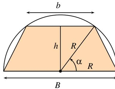
Notons  $\alpha$  l'angle au centre repérant la position d'un sommet du trapèze tel qu'illustré ci-dessus. L'aire du trapèze vaut
