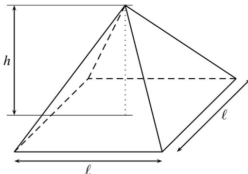
On rappelle que le volume d'une pyramide est donné par  $\frac{1}{3}Ah$  où  $A$  désigne l'aire de la base et  $h$  est la hauteur de la pyramide.
