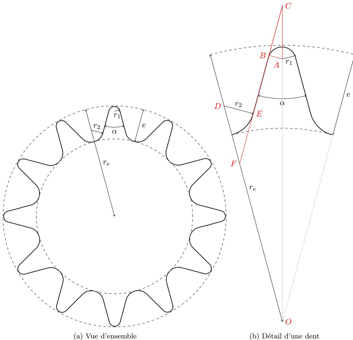
FIGURE 2 – L'engrenage à 12 dents.
